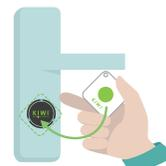
1. Halten Sie die Rückseite des KIWI Transponders so lange an das KIWI-Logo des Knaufs, bis die LED des Knaufs grün aufleuchtet. Anschließend entriegelt die Tür.
